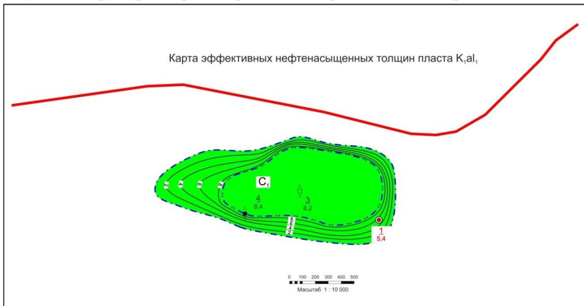
**Рисунок.2.** Карта эффективных нефтенасыщенных толщин пласта  $K_1a_1$  с проектной скважиной № 1.
