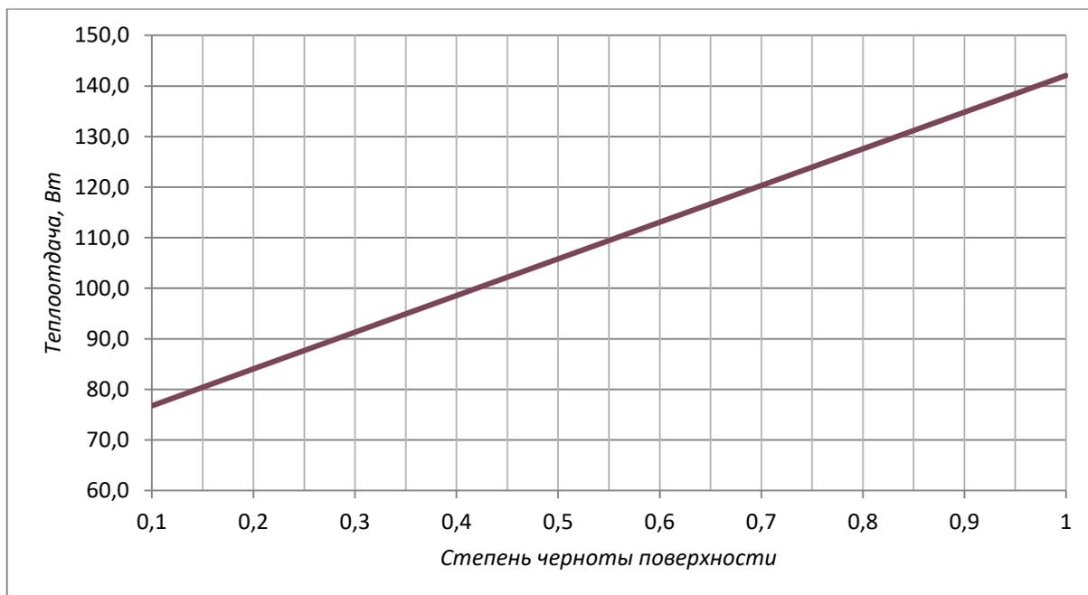
**Рисунок 3.** Зависимость теплоотдачи неизолированной вертикальной трубы от степени черноты
